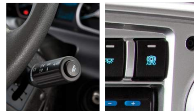
Palanca de accionamiento del freno motor y el Intarder: los frenos auxiliares pueden activarse manualmente o, automáticamente, a través de los sistemas del vehículo.
