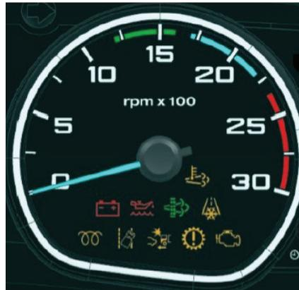
No es necesario realizar una aplicación especial en el periodo de rodaje del motor. Conduzca el vehículo con la marcha adecuada para que el tacómetro permanezca en la zona verde como siempre.
