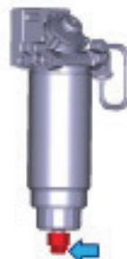
Si la luz de advertencia de "agua en el combustible" se enciende cuando el encendido está conectado afloje o desenganche el sensor de agua integrado debajo del conjunto del filtro y ciérrelo cuando aparezca combustible limpio.
