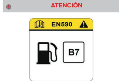
Su vehículo es adecuado para utilizarlo con un combustible con una proporción de biodiésel del 7% (B7).
