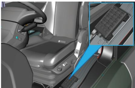
La altura del chasis de los vehículos con suspensión neumática 6x2 se puede ajustar. El control de la SNCE se encuentra a la izquierda del asiento del conductor.
