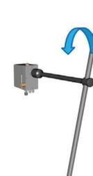
Utilizando el soporte de la rueda que se incluye en la caja de herramientas de su vehículo, gire el tornillo de cabeza hexagonal del cilindro en la dirección de la flecha hasta que la cabina esté completamente inclinada.
