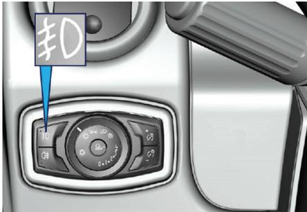
La luz antiniebla delantera está situada en el panel de control de los faros. Encienda este interruptor para obtener una mejor visibilidad y ser visible para el tráfico entrante en condiciones de niebla y donde la visibilidad sea baja. El icono de la luz antiniebla delantera aparecerá en el indicador cuando pulse el interruptor.
