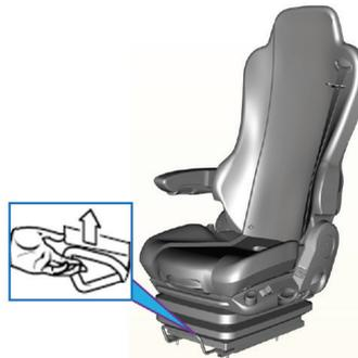
El ajuste frontal y trasero se realiza moviendo el asiento hacia adelante o hacia atrás mientras se tira de la palanca. El asiento se bloqueará con un clic audible cuando se suelte la palanca. El asiento se puede mover completamente hacia adelante o hacia atrás.
