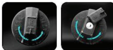
La tapa del depósito de combustible de Ford se abre en sentido contrario a las agujas del reloj en una sola acción en una sola etapa. La tapa vuelve a la posición en la que la bloqueará en una sola acción en una sola etapa cuando se gire en el sentido de las agujas del reloj. La limpieza del depósito de combustible es esencial.
