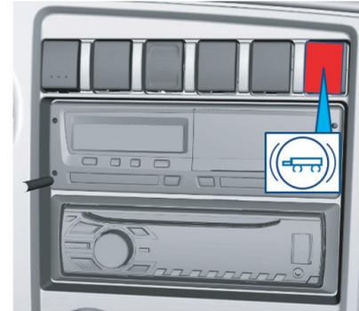
Facilita la operación de conexión o desconexión del remolque al frenar el remolque al conectar el vehículo al remolque o al desconectarlo del mismo.
