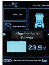
El parpadeo del indicador de estado de la batería muestra que el nivel de carga de la batería es muy bajo. El mejor método en esta condición es mantener el motor encendido inmediatamente para que las baterías puedan cargarse.
