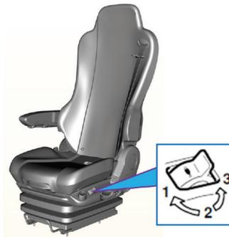
La dureza absorbente del asiento se puede ajustar sin escalones entre suave y duro mediante el botón de ajuste de la dureza.
