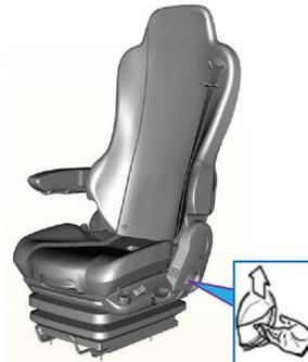
Para desbloquear el respaldo, tire de la palanca de bloqueo hacia arriba. No presione el respaldo al abrir la cerradura.
