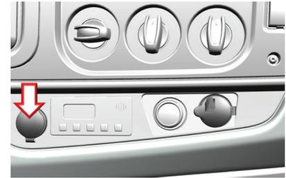
La corriente necesaria para los dispositivos se puede obtener de una toma de corriente de 24 V.
