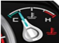
Indica la temperatura del refrigerante del motor. Si el cuadrante del indicador está en el área roja, el motor puede sobrecalentarse.
