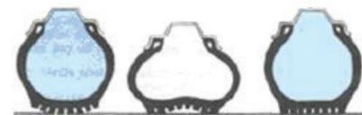
**Sobreinflado**    **Desinflado**    **Presión adecuada de los neumáticos**
