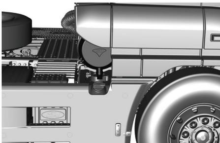
El cilindro de inclinación de la cabina está situado detrás del guardabarros en el lado derecho del vehículo.
