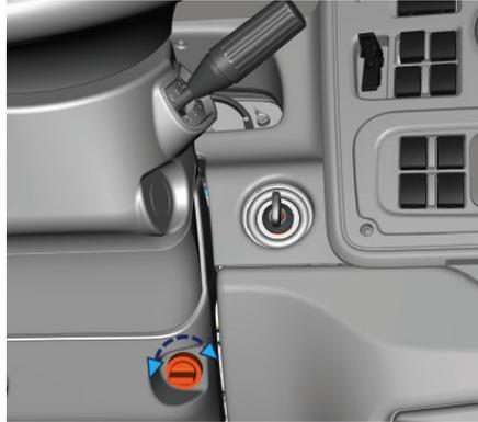
1. Gire la perilla de la columna de dirección en sentido contrario a las agujas del reloj. De este modo, se activará la asistencia de potencia al sistema y se permitirá el ajuste.
