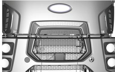
Retire la cubierta del panel de la parrilla frontal para instalar el pasador de tiro.
