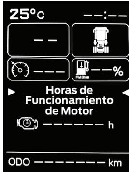
Total de horas de funcionamiento del motor desde la primera puesta en marcha del motor
