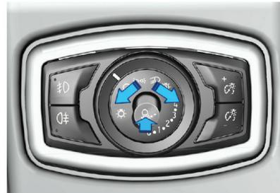
Presione el botón central para ajustar la regulación del alcance luminoso. El pomo debe salir como se muestra en la ilustración. Cuando gire el mando hacia la izquierda (en sentido contrario a las agujas del reloj), bajará el nivel del faro, y cuando gire el mando hacia la derecha (en sentido de las agujas del reloj), subirá el nivel del faro.
