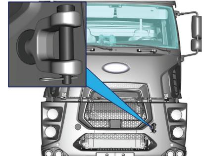
Retire el pasador de arrastre y conecte el cable de remolque.
