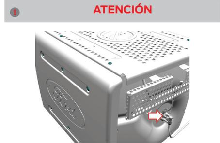
En el silenciador del escape deberán estar disponibles varios sensores e inyector de urea. (En los vehículos Eu5 el inyector de urea está en el tubo de escape) Cuando lave su vehículo, no aplique chorro de agua en el inyector de urea en el silenciador, los sensores y las conexiones eléctricas.
