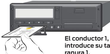
El conductor 1, que conducirá el vehículo, introduce su tarjeta de conductor en la ranura 1.
