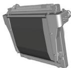
La mosquitera, colocada delante del radiador, es un componente que se asemeja a una cortina y que se puede limpiar.
