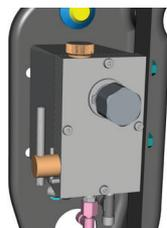
2) Mantenga pulsado el botón amarillo. Para accionar el sistema de elevación de la cabina motorizada, la llave de contacto estará en la posición 2, se aplicará el freno de estacionamiento y la marcha se pondrá en punto muerto.
