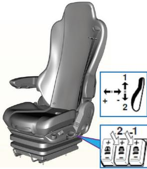
El ajuste del arco delantero del respaldo se puede adaptar al conductor mediante los interruptores delanteros y traseros (1 y 2).
