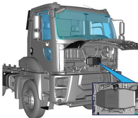
El depósito del lavaparabrisas está situado en la parte delantera de su vehículo. Puede acceder al depósito abriendo el capó. Añada agua y productos de limpieza regularmente antes de que se le acabe el líquido del depósito.
