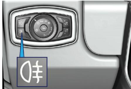
La luz antiniebla trasera está situada en el panel de control de los faros. Encienda este interruptor para obtener una mejor visibilidad y ser visible para el tráfico entrante en condiciones de niebla y donde la visibilidad sea baja. Las luces antiniebla traseras se encienden cuando los faros de cruce y de carretera están encendidos únicamente. El icono de la luz antiniebla trasera aparecerá en el indicador cuando pulse el interruptor.
