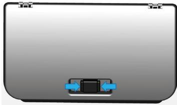
Hay compartimentos de almacenamiento cubiertos en los lados derecho e izquierdo de la consola superior. Presione a ambos lados del botón central para abrir estas cubiertas.
