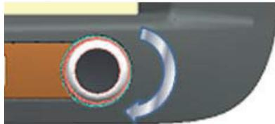
Gire el botón para cambiar la frecuencia con incrementos de 0.05MHz.
