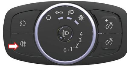
El interruptor de la luz antiniebla trasera está situado en el panel de control del faro. Encienda este interruptor para obtener una mejor visibilidad y ser visible para el tráfico entrante en condiciones de niebla y donde la visibilidad sea baja. Las luces antiniebla traseras se encienden cuando los faros de cruce y de carretera están encendidos únicamente. El icono de la luz antiniebla trasera aparecerá en el indicador cuando pulse el interruptor.
