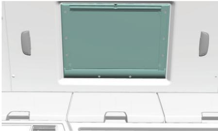
El techo eléctrico se mueve en dirección de apertura o cierre mientras se presionan los botones correspondientes. La operación se detiene automáticamente cuando el techo eléctrico alcanza la posición más alta o más baja. Los botones están activos mientras el encendido está conectado.
