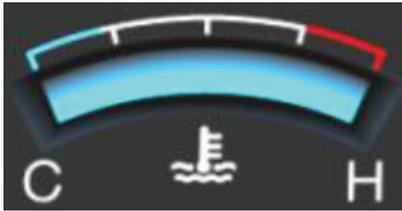
Indica la temperatura del refrigerante del motor.
