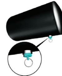
Vacíe el agua de los depósitos todos los días. Tire del anillo unido al grifo hasta que todo el aire sea descargado para drenar el agua dentro de los tanques.
