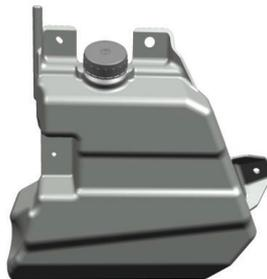
El depósito del lavaparabrisas está situado en la parte delantera de su vehículo. Puede acceder al depósito abriendo el capó. Añada agua y productos de limpieza regularmente antes de que se le acabe el líquido del depósito.
