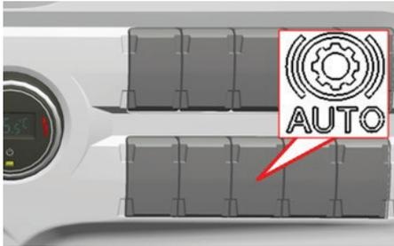
Cuando se pulsa el botón "AUTO" de la consola central, el freno de estacionamiento y el freno motor pueden activarse mediante el freno de pie. Por lo tanto, cuando se acciona el pedal de freno, el freno de motor y el freno de admisión\* se aplican de forma proporcional al recorrido del pedal, además de los frenos de servicio. \*El arrancador no se incluye en el paquete estándar del vehículo; es opcional.
