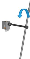
c) Gire el tornillo hexagonal del cilindro de inclinación de la cabina en la dirección de la flecha hasta que la cabina esté completamente inclinada con la llave de cruceta suministrada en la caja de herramientas de su vehículo.
