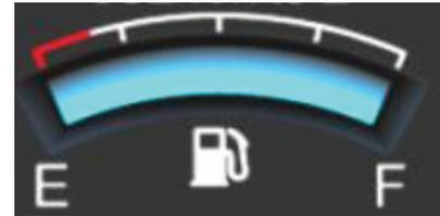
Indica el nivel de combustible en el depósito. La luz amarilla de advertencia indica que el combustible en el tanque es reducido. Llene de inmediato el depósito de combustible. El sistema tomará aire si se baja el combustible.
