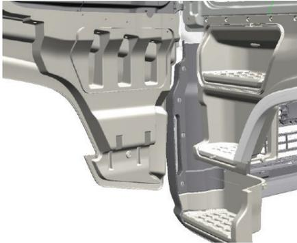
Abra la puerta, gire los cierres desmontables de la pieza en la dirección de la flecha.
