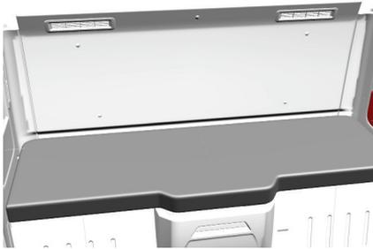
Hay un compartimento plegable en el extremo derecho de la cama inferior. Tire de la manija hacia arriba para levantar el compartimento. Tire de la manija hacia arriba y suéltela para bajar el compartimento.
