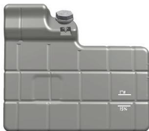
El refrigerante del motor contiene 50% de anticongelante y 50% de agua destilada. El refrigerante circula dentro del bloque del motor y enfría los componentes del motor. Este fluido también enfría el aceite del retardador en los vehículos con retardador.
