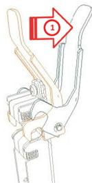
El panel lateral del faldón se libera con el movimiento de los bloqueos en ambos lados delanteros y traseros en la dirección 1.
