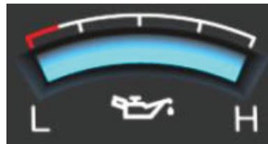
Indica la presión del aceite del motor en "bares". La presión del aceite varía en función de la temperatura del aceite y de la presión de funcionamiento del motor: 3 bar @ 90 °C, 2500 rpm Presión de ralentí: 1,5 bar @ 90 °C, 550rpm La luz de advertencia se encenderá cuando la presión de aceite sea baja. Realice lo siguiente cuando la luz roja de advertencia esté encendida:
