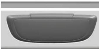
La luz interior se encuentra sobre el parabrisas, en el área central. Se enciende/apaga mediante el interruptor marcado con
