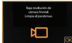
Advertencia de bloqueo del sensor de la cámara
