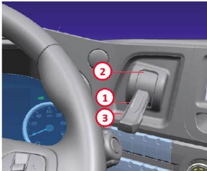
Poner la palanca del freno de estacionamiento en su posición 1. Cuando el freno de estacionamiento está conectado, la pantalla parpadea en rojo.
