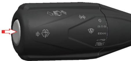
Presione el botón que se muestra con una flecha en la palanca multifuncional izquierda para rociar el líquido limpiador en el parabrisas. La función de pulverización se detendrá cuando suelte el botón.
