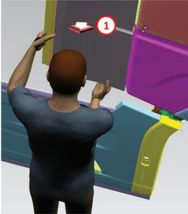
La cubierta lateral se abre sujetándola por arriba y por abajo como se muestra en la imagen y luego tirando de ella hacia afuera (2) del vehículo y luego hacia adelante (2).
