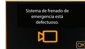
Aviso de mal funcionamiento del sistema de frenado de emergencia
