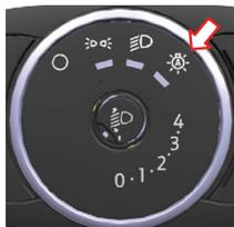
Cuando el control de iluminación está en posición de faro automático, los faros de luz de cruce se encienden automáticamente cuando oscurece por la noche y el sensor detecta que el nivel de iluminación ambiental no es el adecuado.
