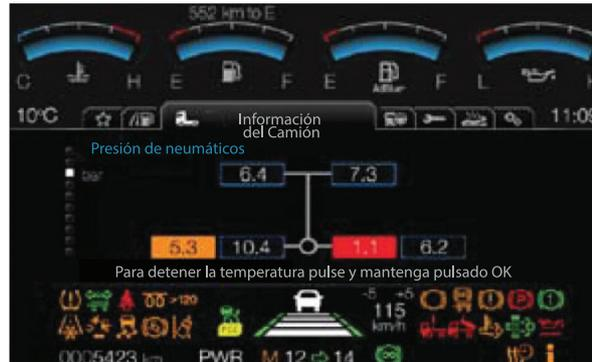
Detenga el vehículo con seguridad, inspeccione los neumáticos e ínflelos para corregir la presión si la luz de advertencia de baja presión de los neumáticos está encendida. Este sistema no reemplaza a los demás procedimientos de mantenimiento de los neumáticos.
