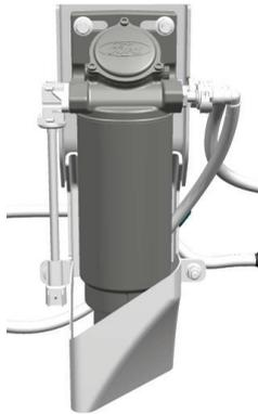
El prefiltro de combustible realiza la filtración inicial del combustible extraído del depósito de combustible. Además, separa el agua dentro del combustible y proporciona combustible separado del agua al motor. El agua filtrada se recoge en el recipiente bajo el conjunto del filtro.
