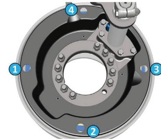
El sistema de frenos de leva Z es un sistema de frenos de tambor de revestimiento. El desgaste de los forros de freno se inspecciona a través de 4 orificios en la placa de freno. Retire los tapones de la placa para la inspección y cámbielos tras esta.
