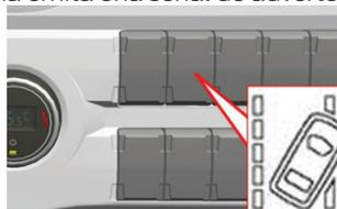
Botón de encendido/apagado del sistema de aviso de cambio de carril
