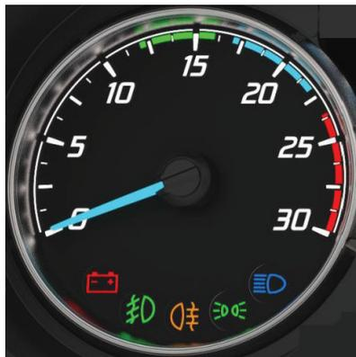
No es necesario realizar una aplicación especial en el periodo de rodaje del motor. Conduzca el vehículo con la marcha adecuada para que el tacómetro permanezca en la zona verde como siempre.
