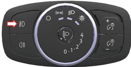
La luz antiniebla delantera está situada en el panel de control de los faros. Encienda este interruptor para obtener una mejor visibilidad y ser visible para el tráfico entrante en condiciones de niebla y donde la visibilidad sea baja. El icono de la luz antiniebla delantera aparecerá en el indicador cuando pulse el interruptor.
