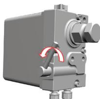
b) Levante el pestillo del cilindro de inclinación de la cabina hacia arriba.
