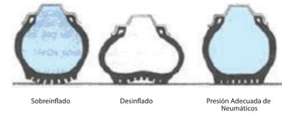
Las bajas presiones causan desgaste en las áreas de los hombros de el neumático. Las altas presiones causan desgaste en las áreas traseras de el neumático.
