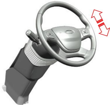
Podrá ajustar el ángulo y la altura del volante en la posición más cómoda para usted mientras conduce.
