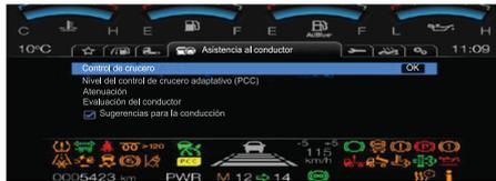
La función de evaluación del conductor puntúa al conductor de acuerdo a su aceleración, anticipación, desaceleración y puntajes de conducción según su consumo de combustible. El conductor deberá recorrer varios kilómetros para iniciar el proceso de evaluación. Los resultados de la evaluación se enviarán al conductor tras haber recopilado la cantidad suficiente de datos<sup>1</sup>.\*
