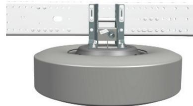
A roda sobresselente encontra-se no lado esquerdo do chassis em veículos com um depósito de combustível único.
