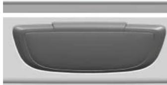
A lâmpada interior é colocada sobre o para-brisas na área central.
