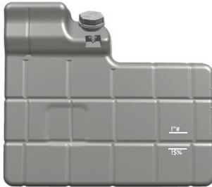
O refrigerante do motor contém 50% de anticongelante e 50% de água destilada. O refrigerante circula no interior do bloco do motor e arrefece os componentes do motor. Este fluido também arrefece o óleo do intarder em veículos com intarder.
