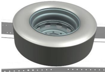
A roda sobresselente encontra-se no chassi em veículos com um depósito de combustível secundário opcional. A saia lateral deverá ser removida para retirar a roda sobresselente.
