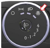
Quando o controlo de iluminação estiver na posição de farol automático, os faróis baixos são ligados automaticamente quando escurece ao entardecer e o sensor deteta que o nível de iluminação ambiente não é adequado.
