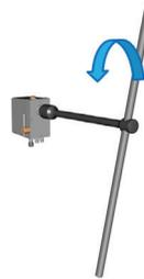
c) Rode o parafuso de cabeça hexagonal no cilindro de inclinação do habitáculo na direção da seta até o habitáculo estar completamente inclinado com a chave de porcas da roda fornecida na caixa de ferramentas do seu veículo.
