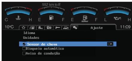
Configuração do sensor de chuva no painel de instrumentos
