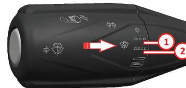
Posição de “limpador para-brisas automático” na alavanca do limpador para-brisas. Se o seu veículo estiver equipado com um limpador para-brisas automático, os limpadores para-brisas deverão funcionar automaticamente, de acordo com a quantidade de chuva quando colocar a alavanca do limpador para-brisas na posição de “limpador para-brisas automático”
