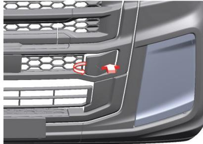
Carregue na cobertura do pino de arrasto a partir do lado indicado com uma seta. A cobertura irá rodar e abrir. Coloque-o na sua base no veículo e carregue sobre ele para instalar a peça.
