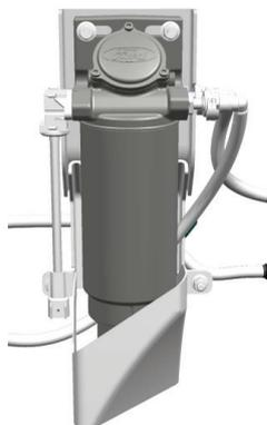
O pré-filtro de combustível executa a filtragem inicial do combustível retirado do depósito de combustível. Para além disso, separa a água no interior do combustível e fornece combustível separado de água ao motor.
