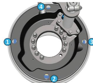
O sistema de travão Z-cam é um sistema de travagem do tipo revestimento-tambor. O desgaste do revestimento do travão é inspecionado a partir de 4 orifícios na placa do travão. Remova os tampões na placa para inspeção e substitua-os após a inspeção.
