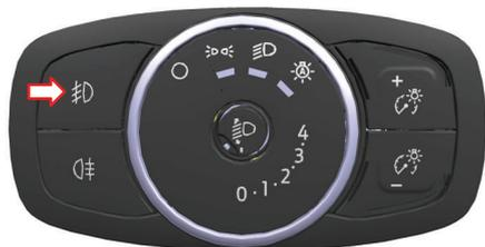
A lâmpada do farol de nevoeiro frontal está colocada no painel de controlo do farol. Ligue este interruptor para obter melhor visibilidade e para estar visível para o trânsito em sentido contrário em condições de nevoeiro e onde a visibilidade é fraca. O ícone da lâmpada de nevoeiro frontal é exibido no indicador quando se carrega no interruptor.
