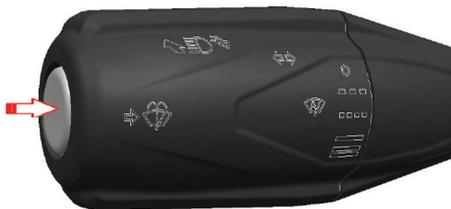
Carregue no botão indicado com uma seta na alavanca multifuncional esquerda para aspergir fluido do limpador para-brisas. A função de aspersor deverá ser parada quando solta o botão.
