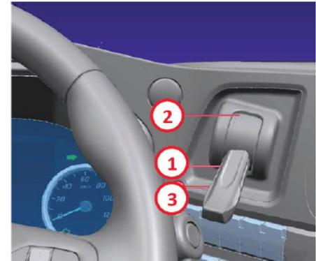
Depois de colocar a alavanca na posição 1, verifique se o veículo com semi-reboque se move carregando na alavanca e puxando a alavanca para baixo (posição 3). Depois, coloque a alavanca na posição de estacionamento (posição 1) novamente. Depois, saia do veículo e aplique o travão de estacionamento do atrelado.
