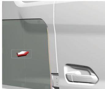
A caixa de ferramentas está localizada por detrás das portas do condutor e passageiro, conforme indicado na figura.
