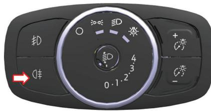
O interruptor da lâmpada do farol de nevoeiro traseiro está colocado no painel de controlo do farol. Ligue este interruptor para obter melhor visibilidade e para estar visível para o trânsito em sentido contrário em condições de nevoeiro e onde a visibilidade é fraca. As lâmpadas de nevoeiro traseiras iluminam-se apenas quando os faróis altos e baixos são ativados. O ícone da lâmpada de nevoeiro traseiro é exibido no indicador quando se carrega no interruptor.
