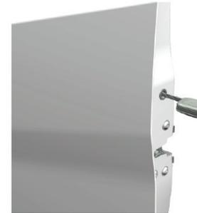
Existem trincos de emergência nas portas esquerda e direita do seu veículo. O trinco está integrado na porta na área exibida na figura e, caso necessite de deixar o veículo quando as suas baterias se tiverem esgotado ou no caso de um problema de potência, deverá rodar o trinco de emergência para trancar as portas. As portas permanecem trancadas se forem fechadas depois de rodar a emergência. O trinco de emergência roda-se com a pega de metal, sendo possível trancar e destrancar ambos.
