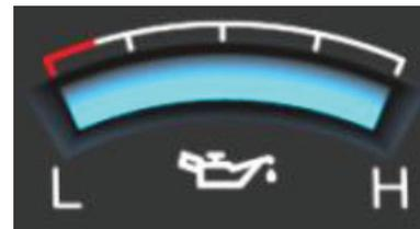
Indica a pressão do óleo do motor em "bars". A pressão do óleo varia dependendo da temperatura do óleo e da velocidade do motor. Pressão operativa: 3 bar @ 90 °C, 2500 rpm Pressão de suspensão: 1,5 bar @ 90 °C, 550 rpm. A lâmpada de aviso irá acender-se quando a pressão de óleo estiver baixa. Execute o seguinte quando se acende a lâmpada de aviso vermelha:
