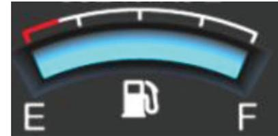
Indica o nível de combustível no depósito. A luz de aviso amarela indica que o combustível no depósito é reduzido. Reabasteça o combustível imediatamente. O sistema vai admitir ar se o combustível descer.
