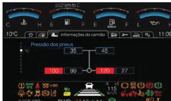
Pare o veículo em segurança, inspecione os pneus e encha-os até à pressão correta se a lâmpada de aviso de pressão baixa estiver acesa. Este sistema não substitui os procedimentos de manutenção corretos.
