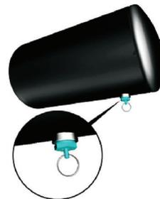
Escoe a água dos depósitos todos os dias. Puxe a anilha anexada à torneira até que todo o ar saia para drenar a água no interior dos depósitos.
