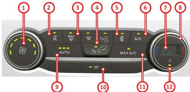
**1- Controlo da velocidade do ventilador:** Ajusta a quantidade de ar que é ventilado para o interior do veículo.
