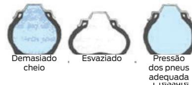
A pressão baixa poderá causar desgaste nas áreas de ombro do pneu. A pressão alta poderá causar desgaste nas áreas traseiras do pneu.
