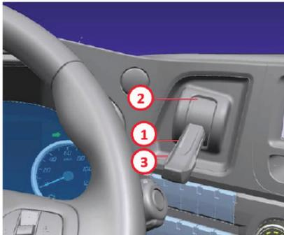
Coloque a alavanca do travão de estacionamento na posição 1. Quando o travão de estacionamento é aplicado, o monitor pisca a vermelho.
