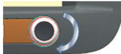
Rode o botão para mudar a frequência com incrementos de 0,05 MHz.
