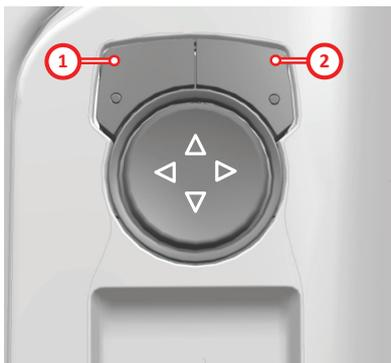
Carregue no botão n.º 1 para o ajuste do espelho do lado do condutor. Ajuste o espelho movendo as setas para a frente e para trás e para a esquerda e para a direita e, depois, carregue no botão n.º 1.
