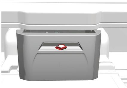
Existe uma gaveta do compartimento na área do leito. Puxe-a para si para a abrir. A capacidade do compartimento de armazenamento sob o leito é de 45 kg sem um frigorífico e de 30 kg com um frigorífico.
