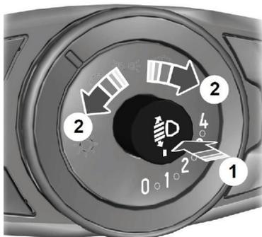
Carregue no botão no interruptor do farol para este sair. Rode o botão para o configurar no ajuste de nivelamento do farol necessário. Carregue no botão no interruptor do farol para o colocar na posição fechada.
