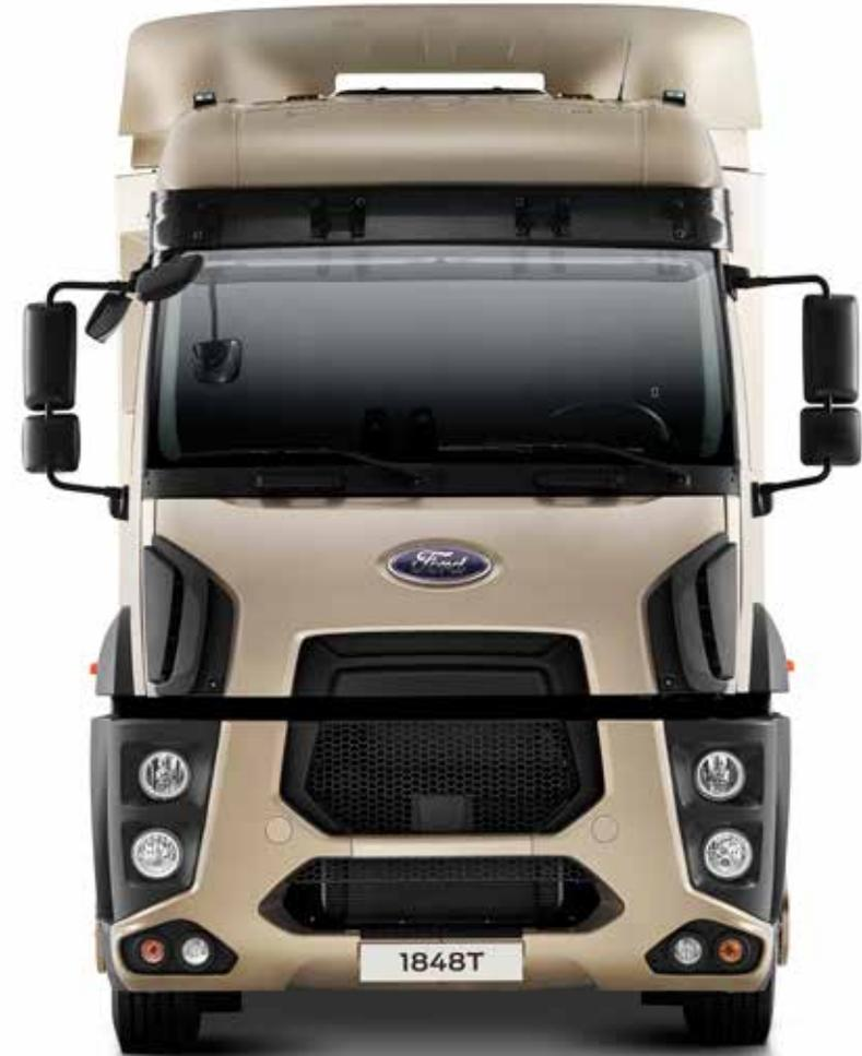
En caso de cualquier daño, el parachoques frontal modular facilita una reparación económica al permitir sustituir exclusivamente las piezas dañadas.
