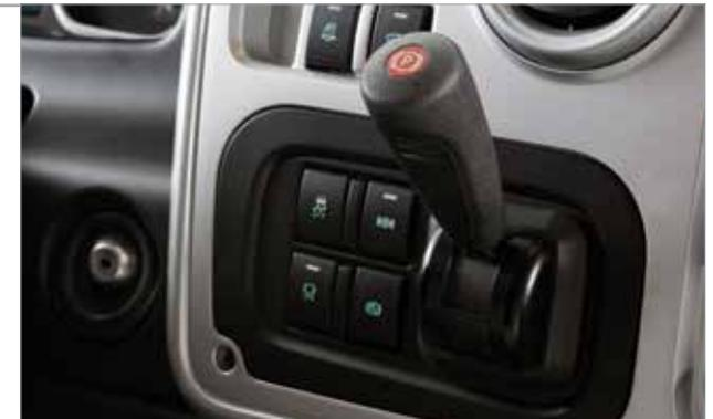
Los botones de ESP, Hillholder y el freno del remolque están colocados en lugares de fácil acceso.
