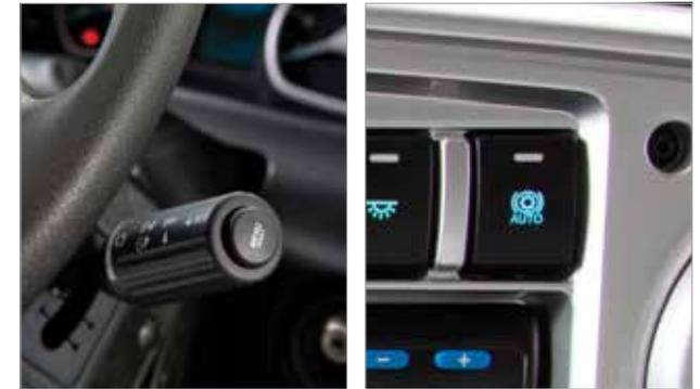
Palanca de accionamiento del freno motor y el Intarder: Puede activar los frenos auxiliares manualmente o puede habilitar al vehículo para que los configure por usted.
