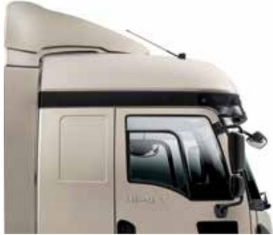
El spoiler, el cortavientos abatible y el deflector frontal minimizan la resistencia al viento y proporcionan ahorro de combustible junto con una apariencia estética.
