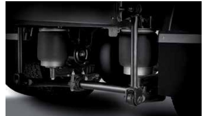
La nueva suspensión neumática trasera desarrollada recientemente está diseñada para los modelos 4x2 y 6x2. Además de la comodidad de conducción única, garantiza un transporte mucho más seguro de cargas frágiles.
