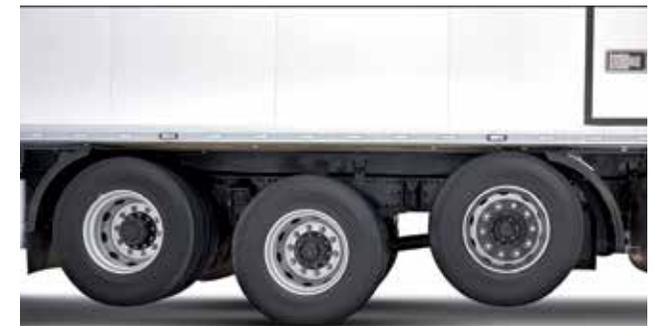
Para vehículos con tipo de eje 6x2 y 8x2, en estado descargado, el eje trasero no está en contacto con el suelo. Este mecanismo evita el desgaste de neumáticos innecesario. Cuando se detiene el vehículo para cargarlo, los neumáticos descienden automáticamente gracias a esta función Auto-drop (descenso automático).
