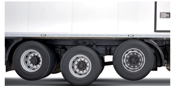
Este mecanismo evita el desgaste innecesario de neumáticos en vehículos 6x2 y 8x2 descargados. Cuando se detiene el vehículo para cargarlo, los neumáticos descienden automáticamente. Los 6x2 con motores Ecorotorq de 9 L también pueden incorporar en opción un tercer eje direccional con control electrónico y suspensión neumática, que garantiza mejor maniobrabilidad, precisión y radios de giro más pequeños.
