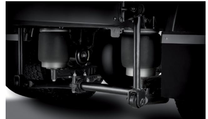
El sistema de suspensión neumática trasera, diseñado para los modelos 4x2 y 6x2, garantiza un gran confort de marcha y mayor seguridad con cargas frágiles.
