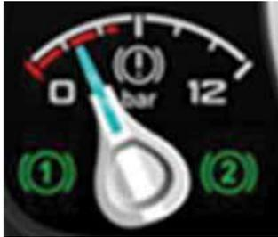
Hay 2 circuitos de sistema de aire independientes que alimentan los sistemas de frenos delanteros y traseros. Puede leer las presiones de estos sistemas desde un solo indicador de presión de aire. El indicador muestra automáticamente el valor de presión de la línea con baja presión.
