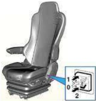
Los calefactores eléctricos del respaldo y del cojín del asiento se accionan en dos pasos pulsando el interruptor correspondiente..
