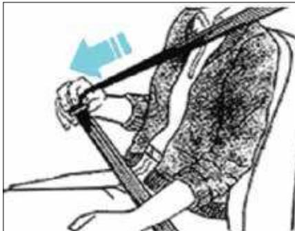
Tire del cinturón de seguridad continuamente desde el carrete. El cinturón de seguridad se puede bloquear si se tira demasiado rápido o si el vehículo está en una pendiente. En este caso, suelte el cinturón de seguridad y deje que se retraiga un poco, luego inténtelo de nuevo. Escuche el clic de bloqueo cuando inserte el pestillo del cinturón de seguridad en la hebilla. De lo contrario, el cinturón de seguridad no está abrochado.
