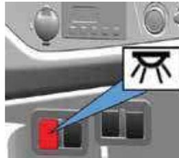
En la cúpula del interior del vehículo hay dos luces de señalización, una en el lado del conductor y otra en el del copiloto. Estas luces se encienden gracias a un interruptor situado en la consola central.
