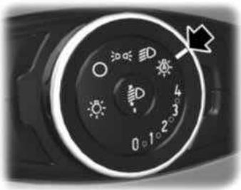
En situaciones de poca luz, los faros se encenderán automáticamente en caso de que el control de iluminación esté en la posición de luces automáticas.
