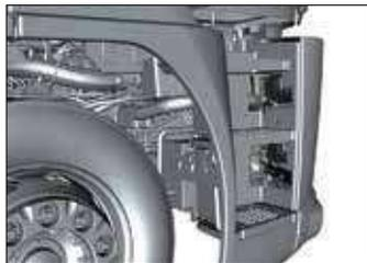
Utilice las tapas de los escalones de la puerta para cambiar las bombillas de los faros de luz de cruce y de carretera.
