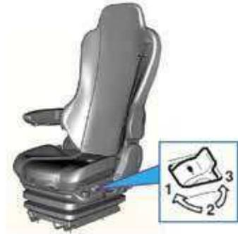
La dureza absorbente del asiento se puede ajustar sin escalones entre suave y duro mediante el botón de ajuste de la dureza.
