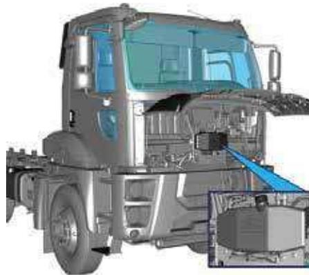
El depósito del lavaparabrisas está situado en la parte delantera de su vehículo. Puede acceder al depósito abriendo el capó. Añada agua y productos de limpieza regularmente antes de que se le acabe el líquido del depósito.
