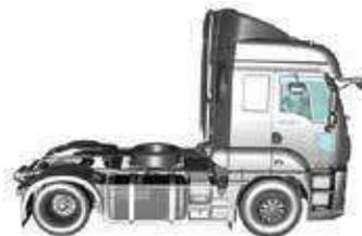
A la derecha del vehículo hay un depósito de combustible de aluminio. Los vehículos con doble depósito tienen depósitos auxiliares de combustible a la izquierda.
