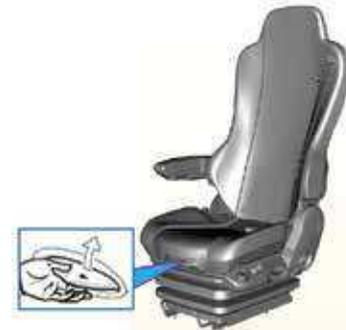
Tire del botón de la izquierda hacia arriba para ajustar la inclinación del asiento. El asiento se puede ajustar a la posición deseada aplicando su peso hacia adelante o hacia atrás al mismo tiempo.
