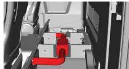
Se utiliza el de tipo seco Eberspacher airtronic D2. Este dispositivo se encuentra bajo la cama inferior, dentro de la cabina. El panel de control está situado en la consola central.
