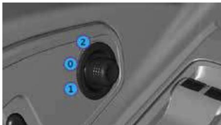
Ajuste el espejo retrovisor (nº 1) con el botón giratorio del reposabrazos de la puerta del conductor. Coloque la perilla en la posición 1 para el ajuste del espejo lateral del conductor.
