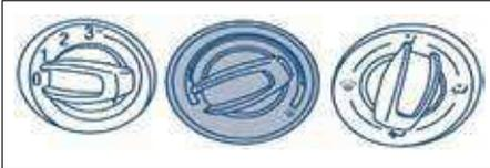
Gire el mando de temperatura hasta la zona roja para el flujo de aire caliente.
