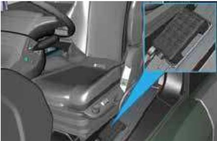
La altura del chasis de los vehículos con 4 fuelles de aire en el eje trasero puede ser ajustada por el control.
