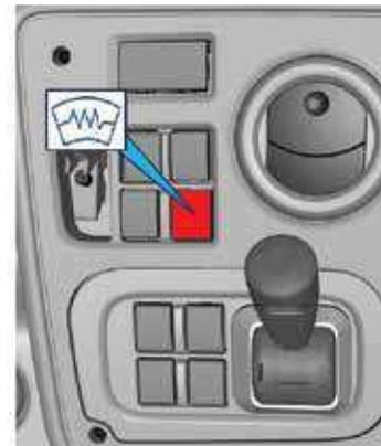
Para activarlo: pulse el botón del panel de control mientras el motor está encendido. Para desactivarlo: La resistencia se desactivará automáticamente después de 5 minutos. Presione el botón de nuevo para desactivar el calefactor cuando esté activado.
