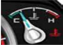
Indica la temperatura del refrigerante del motor.
