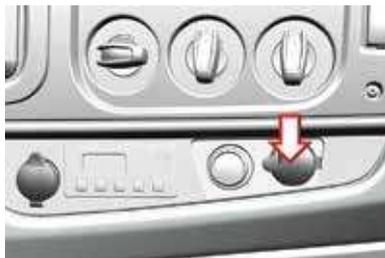
El tomacorriente de 12 V puede proporcionar energía para dispositivos de hasta 100 W.
