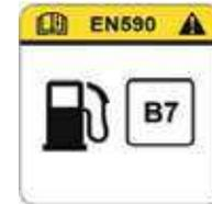
Su vehículo es adecuado para utilizarlo con un combustible con una proporción de biodiésel del 7% (B7).
