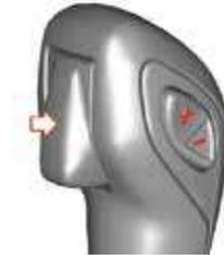
El desplazamiento hacia arriba/hacia abajo se hará con los botones +/- donde está la perilla de cambio. Accionamiento '- El cambio manual se hará si el conductor pulsa el botón + o - durante más de 1 segundo.
