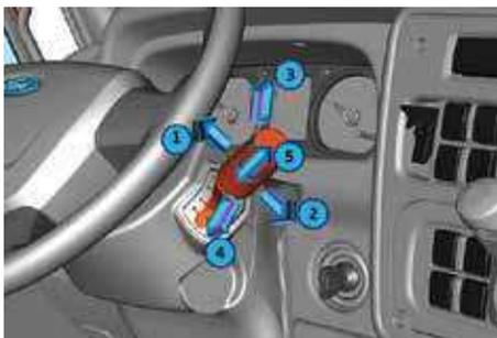
Tire de la palanca hacia usted para activarla, (posición 1), y en pantalla se
