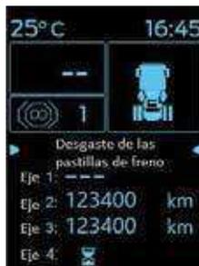
En la pantalla se mostrará la información sobre la pastilla desgastada. En la pantalla se puede ver en qué eje se deben cambiar los frenos. Se deberán cambiar a la vez las pastillas de freno de ambos lados del mismo eje
