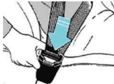
Presione el botón rojo de la hebilla para soltar el cinturón de seguridad. Luego, suelte el cinturón lentamente para permitir que se enrolle completamente en el carrete.
