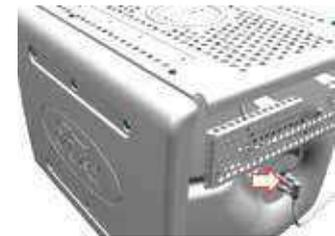
En el silenciador del escape deberán estar disponibles varios sensores e inyector de urea. (En los vehículos Eu5 el inyector de urea está en el tubo de escape) Cuando lave su vehículo, no aplique chorro de agua en el inyector de urea en el silenciador, los sensores y las conexiones eléctricas.
