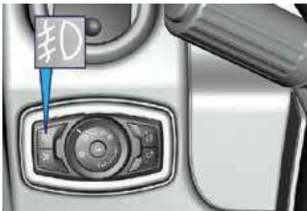
La luz antiniebla delantera está situada en el panel de control de los faros. Encienda este interruptor para obtener una mejor visibilidad y ser visible para el tráfico entrante en condiciones de niebla y donde la visibilidad sea baja. El icono de la luz antiniebla delantera aparecerá en el indicador cuando pulse el interruptor.
