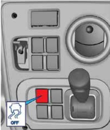
Es posible que desee desactivar el ESP en condiciones de carreteras blandas. En este caso, pulse el interruptor de cancelación del ESP situado en la consola central.
