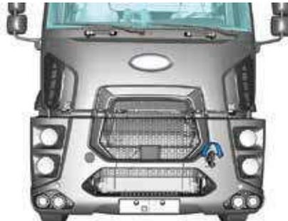
Instale el pasador de arrastre girándolo en el sentido de las agujas del reloj como se muestra en la ilustración.
