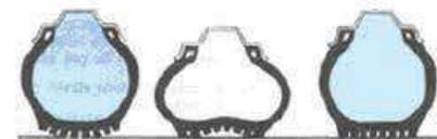
**Sobreinflado**    **Desinflado**    **Presión adecuada de los neumáticos**
