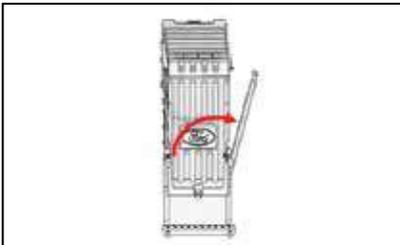
Abra el perfil de conexión superior del soporte del escalón debajo de la tapa de la batería en la dirección de la flecha.
