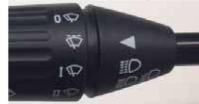
Posición automática del Interruptor del limpiaparabrisas ("Autowipers")
