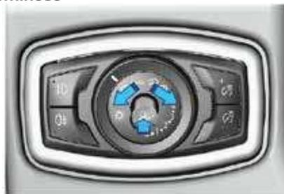
Presione el botón central para ajustar la regulación del alcance luminoso. El pomo debe salir como se muestra en la ilustración. Cuando gire el mando hacia la izquierda (en sentido contrario a las agujas del reloj), bajará el nivel del faro, y cuando gire el mando hacia la derecha (en sentido de las agujas del reloj), subirá el nivel del faro.
