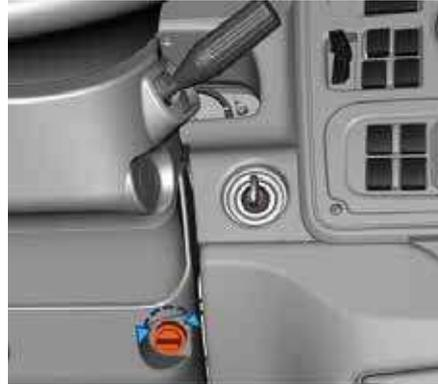
1. Gire la perilla de la columna de dirección en sentido contrario a las agujas del reloj. De este modo, se activará la asistencia de potencia al sistema y se permitirá el ajuste.
