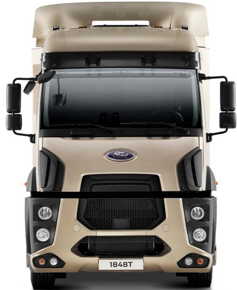
El parachoques frontal modular facilita una reparación económica en caso de daños estructurales, ya que permite sustituir exclusivamente las piezas dañadas.
