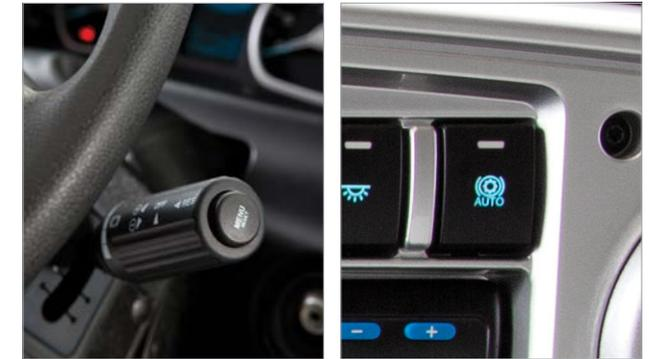
Palanca de accionamiento del freno motor y el Intarder: los frenos auxiliares pueden activarse manualmente o, automáticamente, a través de los sistemas del vehículo.
